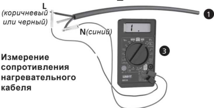
Измерение сопротивления нагревательного кабеля
