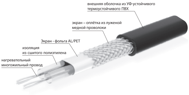
Конструкция нагревательного кабеля ELEKTRA VCDR
