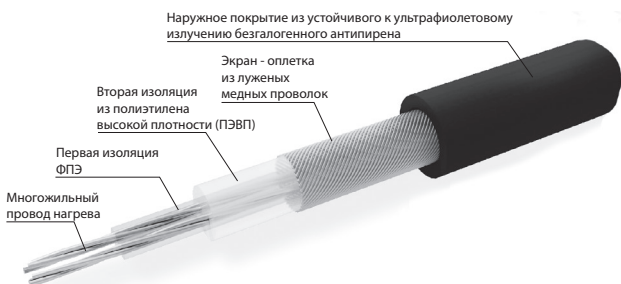
Конструкция нагревательного кабеля ELEKTRA TuffTec™
