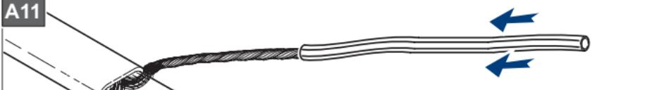
Установите желто-зеленую трубку длиной 160мм на скрученную в жгут экранирующую оплетку.
