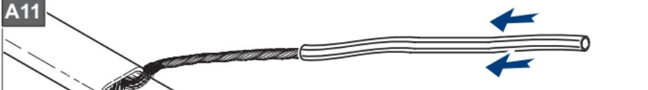
Das grün-gelbe Rohr mit der Länge 160mm auf den Schutzschirm aufziehen.
